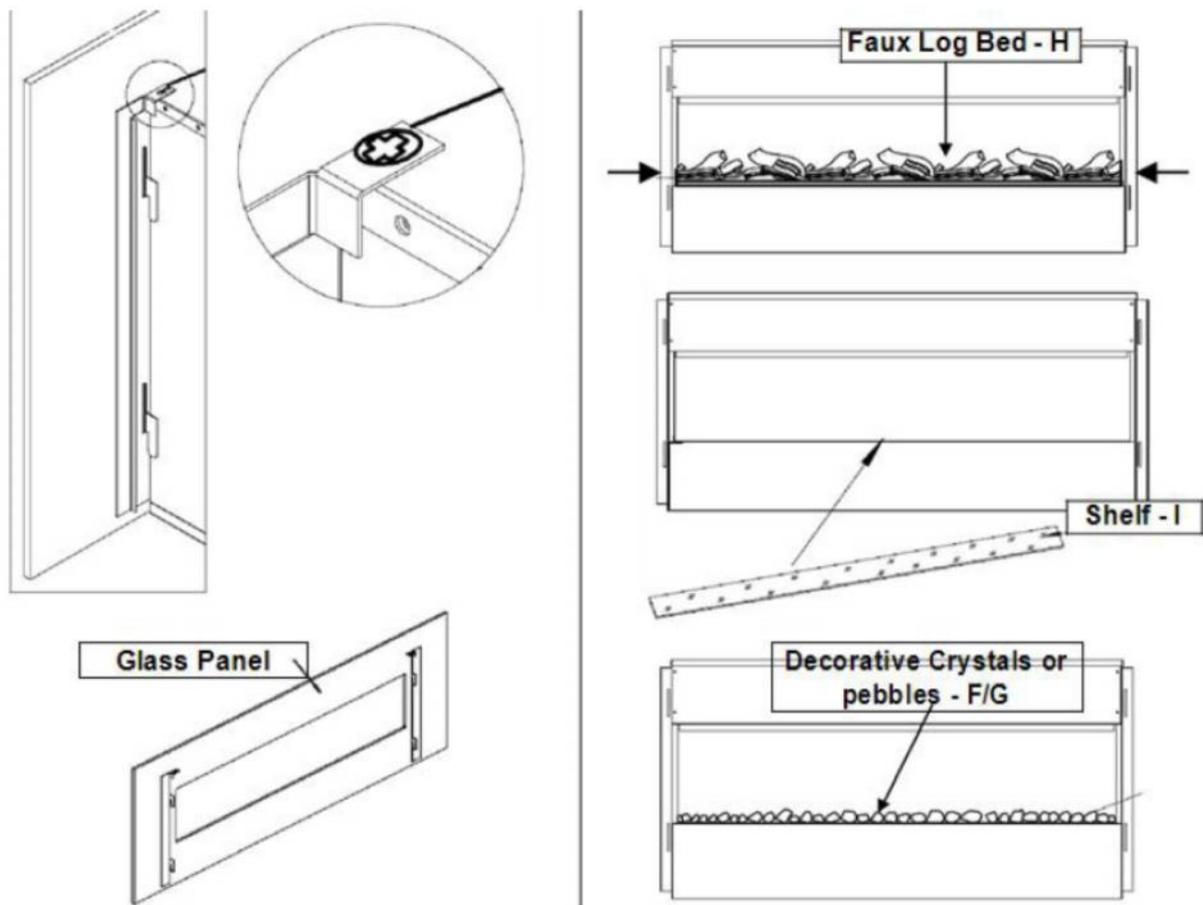
SCHRITT 6A: Während eine Person die Glasplatte hält, entfernen Sie die beiden Schrauben an der oberen Kante des Kamins mit einem Schraubendreher.
