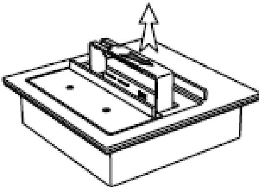
Der Hebegriff wird dazu benutzt die Brennkammer aus der Trägerplatte auf der Innenseite des Kamins für die Reinigung und Befüllung heraus- und hineinzuheben. Schritt 1: Verbinden sie Teil A mit Teil B wie es in der nebenstehenden Abbildung angezeigt wird. Sobald sie die Lippe von Teil A in den Schlitz von Teil B eingesetzt haben, drehen sie Teil A um 90 Grad und verschließen sie beide Teile zu einem Griff.
