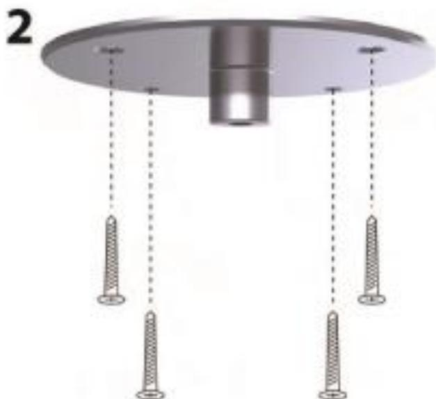
2 – Bringen sie die Basisplatte an der Decke an und schrauben sie die Schrauben in die Dübel (Befestigungsschrauben werden nicht mitgeliefert).
