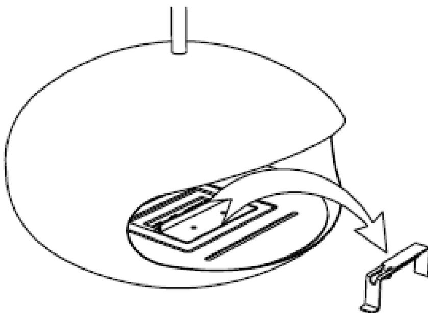
Ihr Cocoon Brenner ist nur betriebsbereit. Befolgen sie die jeweiligen Schritte auf den nachfolgenden Seiten, um diese Feuerstelle korrekt zu befüllen, anzuzünden, auszuschalten und die Brennkammer neu aufzufüllen. Stellen sie immer sicher, dass der Hebegriff jeweils von der Brennkammer entfernt wurde (siehe Abbildung), wenn das Gerät außer Betrieb ist, sonst wird dieser Teil zu heiß zum Anfassen und könnte Verletzungen verursachen.
