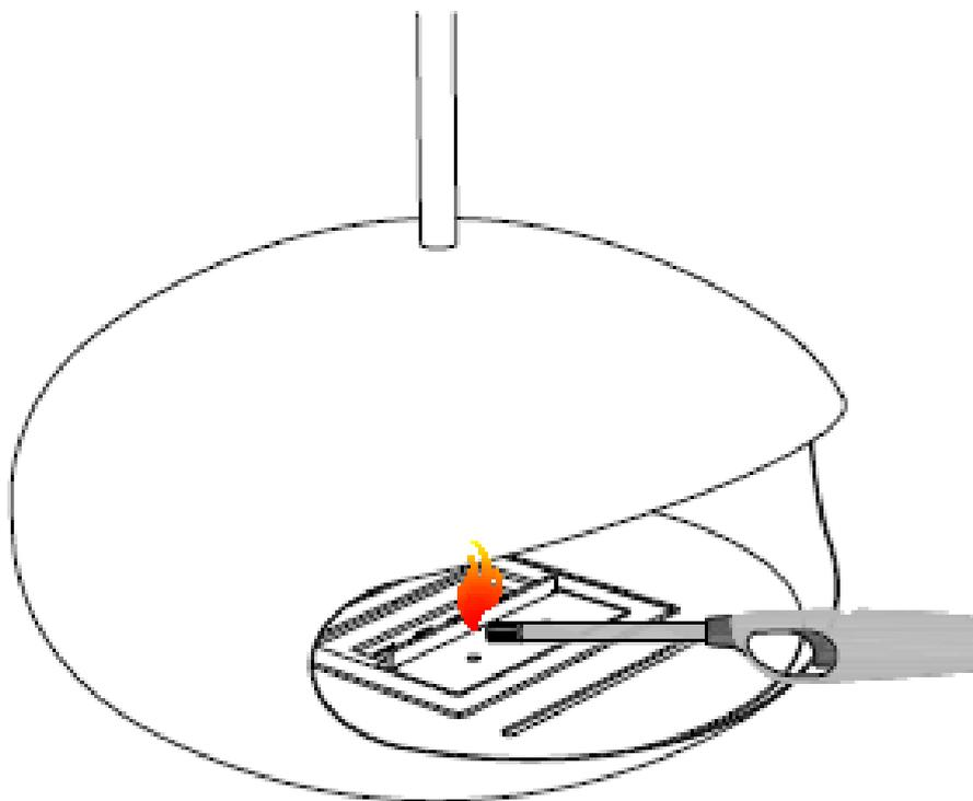
Benutzen sie einen Gasanzünder (mit einem langen Arm) und stehen sie in sicherer Entfernung von der *Brennkammer*, während sie vorsichtig die Flamme – wie oben angezeigt – an die *Brennkammer* halten, um diese anzuzünden. Sie sollten immer dafür sorgen, dass sie einen Feuerlöscher der Klasse B in der Nähe haben, wenn sie die *Brennkammer* anzünden.
