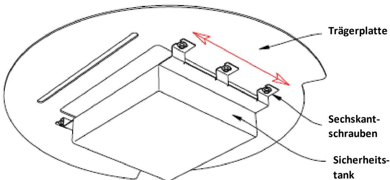
Weitere Einstellungen für die Position der Trägerplatte können durch das Anpassen (leichtes Vor- und Zurückschieben) des Sicherheitstanks erreicht werden. Hierfür muss man die 6 Sechskantschrauben etwas lösen. Stellen sie immer sicher, dass der Sicherheitstank unterhalb der Trägerplatte nach diesen Einstellungen jeweils wieder gut festgeschraubt ist.
