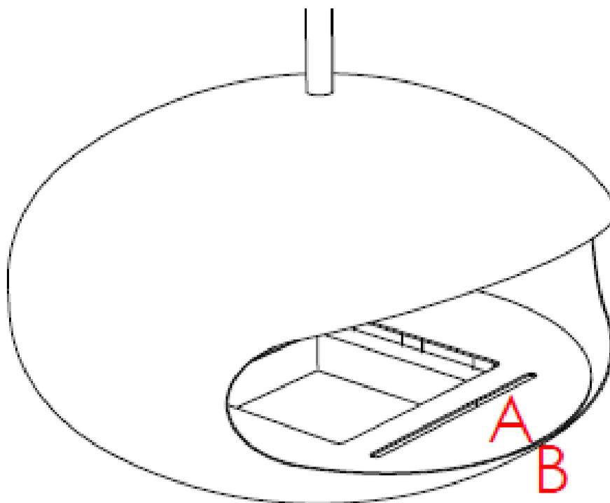
**HINWEIS:** Einstellungsanleitungen auf dieser und der folgenden Seite zeigen die relativen Positionen von (A) und (B), welche für die Luftzufuhr im Kamin kritisch sind und somit notwendig für den reibungslosen Betrieb der *Brennkammer*.
