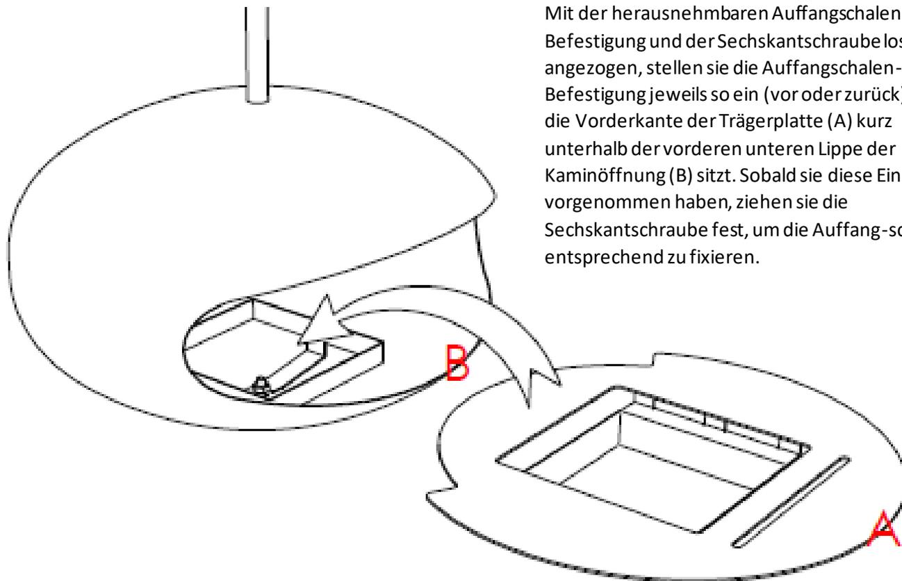
Mit der herausnehmbaren Auffangschalen-Befestigung und der Sechskantschraube lose angezogen, stellen sie die Auffangschalen-Befestigung jeweils so ein (vor oder zurück), dass die Vorderkante der Trägerplatte (A) kurz unterhalb der vorderen unteren Lippe der Kaminöffnung (B) sitzt. Sobald sie diese Einstellung vorgenommen haben, ziehen sie die Sechskantschraube fest, um die Auffangschale entsprechend zu fixieren.
