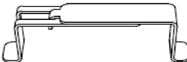
Die **Hebegriffe** werden mitgeliefert, um die *Brennkammer* zum Auffüllen herauszuheben. Diese sollten niemals benutzt werden, wenn sich eine Flamme in der *Brennkammer* befindet oder wenn diese heiß ist. Warten sie mindestens 45 Minuten nachdem die *Brennkammer* abgelöscht worden ist, bevor sie diese Hebegriffe zum Nachfüllen benutzen: Die Anleitung hierzu finden sie auf der folgenden Seite.
