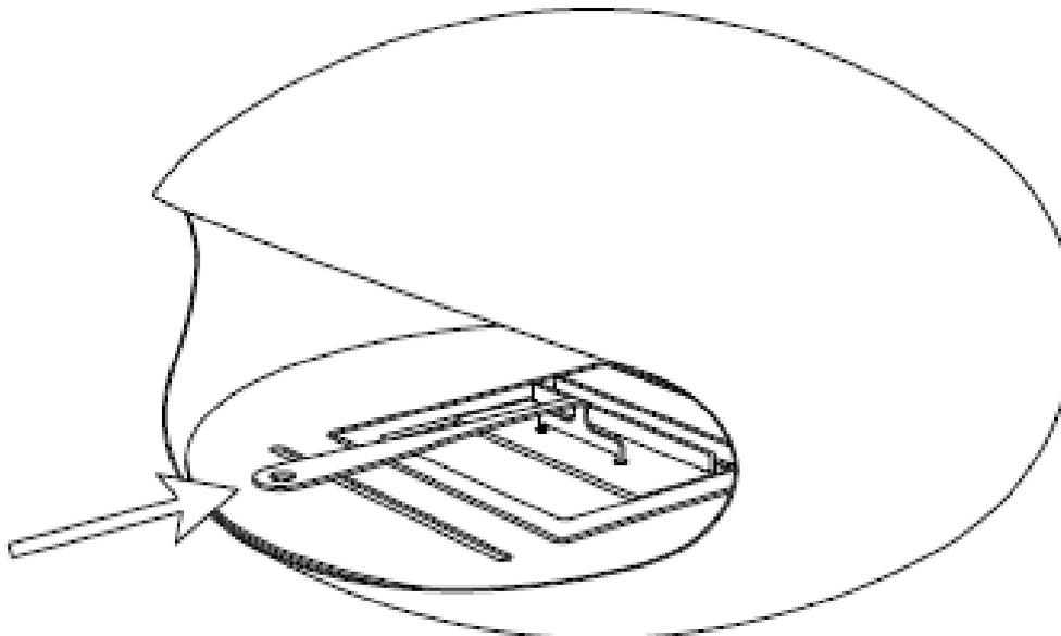
Um die Flamme auszulöschen, stecken sie bitte die beiden Endspitzen des *Schiebedeckel-Griffs* in die jeweiligen Löcher im *Schiebedeckel* auf der *Brennkammer* und schieben sie diesen *Schiebedeckel* von sich weg zu, bis die Flamme aus ist.
