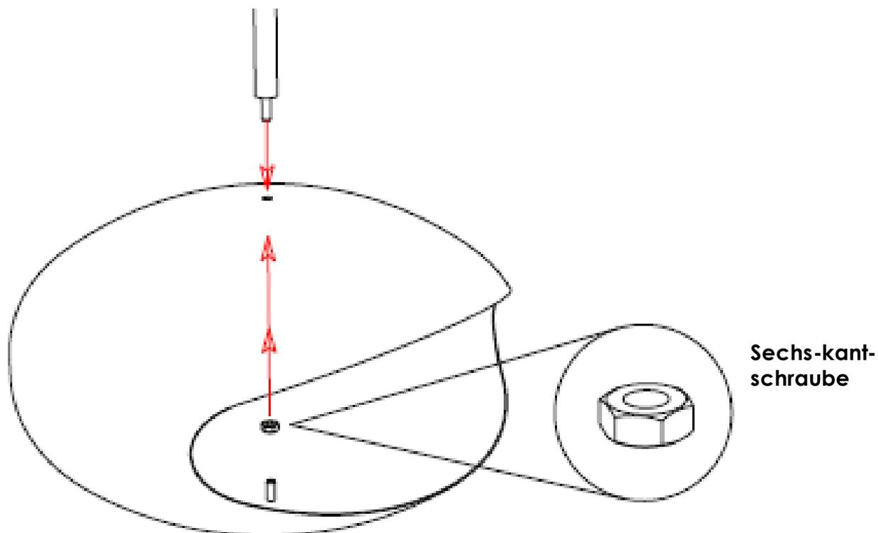
Positionieren sie den Kamin an die Hängestange und sichern sie ihn von innen mit der Sechskantschraube.
