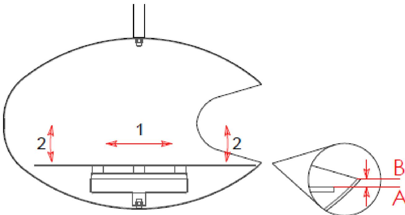
Die Feinjustierung der entnehmbaren *Auffangschale* jeweils nach vorn oder zurück (1) ermöglicht die notwendige Höheneinstellung (2) der *Trägerplatte*.
