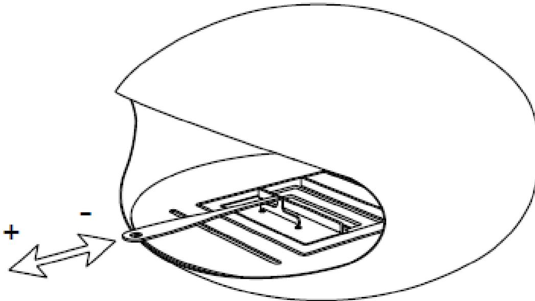
Um die Flamme zu regulieren, stecken sie die beiden Endspitzen des *Schiebedeckel-Griffs* in die jeweiligen Löcher des *Schiebedeckels* der *Brennkammer* und schieben sie diesen *Schiebedeckel* jeweils vor oder zurück, um die Flammengröße zur regulieren.
