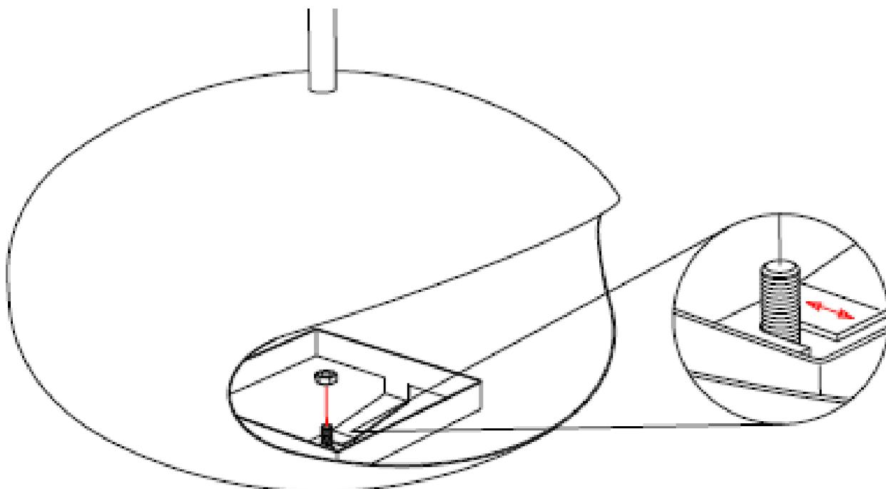
**HINWEIS:** Einstellungsanleitungen auf dieser und der folgenden Seite zeigen die relativen Positionen von (A) und (B), welche für die Luftzufuhr im Kamin kritisch sind und somit notwendig für den reibungslosen Betrieb der *Brennkammer*.
