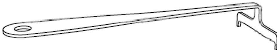
Mit dem **Schiebedeckel-Griff** stellt man die Intensität der Flamme ein, indem man den *Schiebedeckel* vor- oder zurückschiebt. Mit diesem Griff löscht man auch die Flamme, indem den *Schiebedeckel* in die geschlossene Position schiebt.
