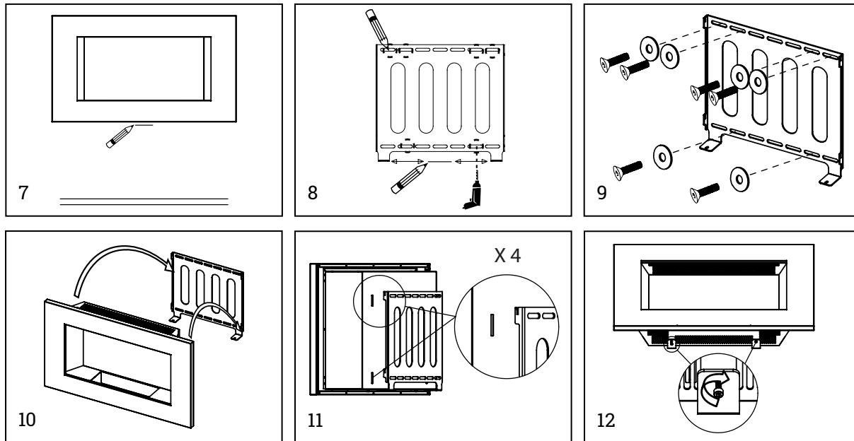
14. Legen Sie das Unterteil der Wandbefestigung an der Markierung an und prüfen Sie mit Hilfe einer Wasserwaage, dass die Platzierung genau horizontal ist. Zeichnen Sie danach die Löcher für die mitgelieferten Befestigungsschrauben mit einem Stift vor. Die Wandbefestigung dient hierbei als Schablone. Vauni empfiehlt 6-8 Schraubpunkte. Bohren Sie anschließend Löcher in passender Größe an den Markierungen vor (Abb. 8).
