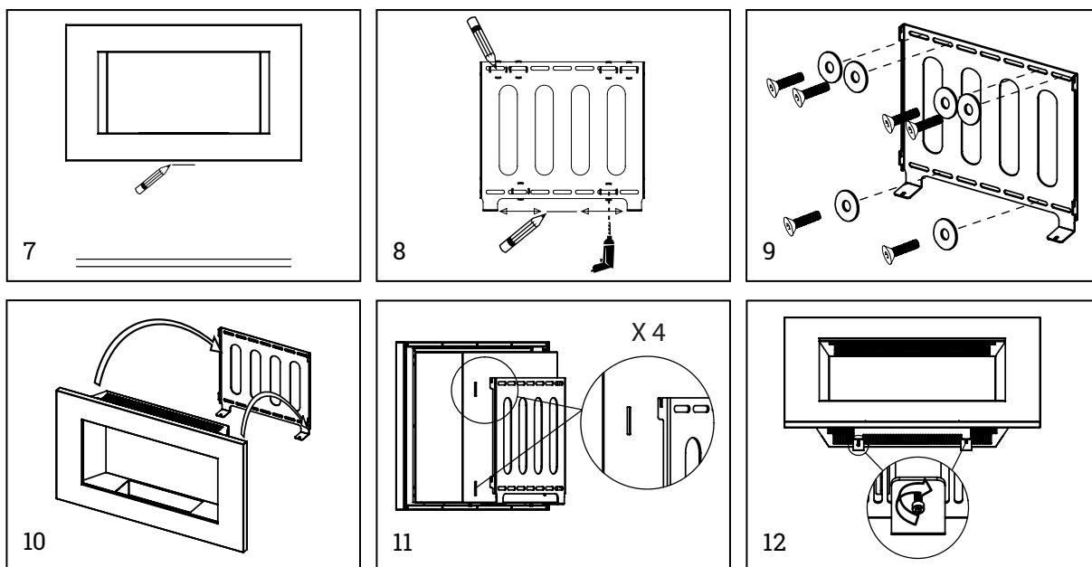
17. Skruva fast de två låsskruvarna på kaminens undersida (Figur 12). Kontrollera att kaminen sitter rakt och stabilt.
