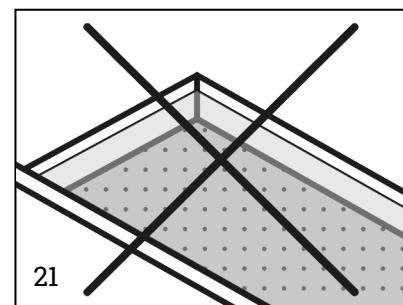
4. Var noga med att undvika allt spill – eventuellt spill torkas bort med en bit papper. Vid överfyllning – använd lämpligt redskap för att ta bort överflödigt bränsle så att det hamnar i nivå med brännarsilen.
