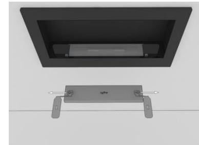
Schieben Sie dann den Deckel über den Brenner und decken Sie die Öffnung ab, indem Sie die beiden Handgriffe kontinuierlich nach außen schieben. Dies sollte gleichmäßig und gleichzeitig über die gesamte Breite erfolgen.
