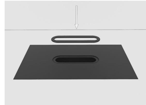
**LÖSCHEN** - Fassen Sie die Kappe mit dem mitgelieferten Stahlgriff am vorstehenden Nippel und decken Sie damit die Öffnung ab, aus der die Flamme austritt.
