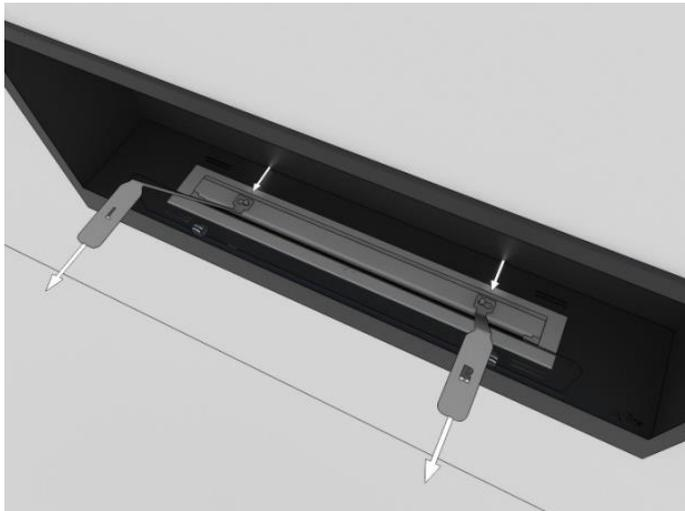
**LÖSCHEN:** nach dem Anheizen des Kamins wird empfohlen, die gesamte verbrauchte Menge an Biokraftstoff zu verbrennen. Wenn es notwendig ist, die Kamine zu löschen, decken Sie das Feuerloch ab, bevor Sie den gesamten Brennstoff verbrennen. Verwenden Sie zum Abdecken der Feuerstelle das mitgelieferte Spezialwerkzeug - eine rechteckige schwarze Kappe mit dem INFIRE-Logo.
