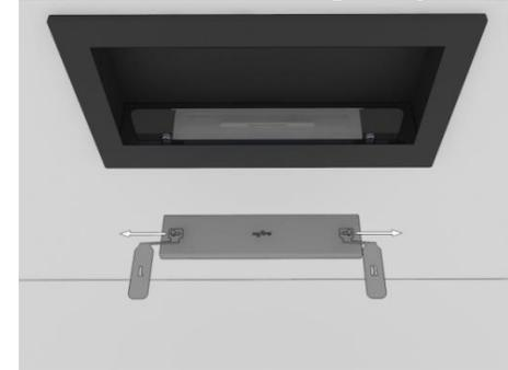
Schieben Sie dann den Deckel über den Brenner und decken Sie die Öffnung ab, aus der die Flamme entweicht, indem Sie die beiden Handgriffe kontinuierlich nach außen schieben. Dies sollte gleichmäßig und gleichzeitig über die gesamte Breite erfolgen.
