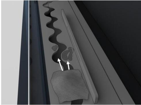
2. Bringen Sie das Feuer mit einem Feuerzeug näher an die Brennstoffoberfläche in der Feuerstelle.
