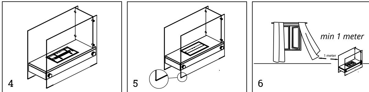
6. Eldstaden levereras med transparenta skyddslistor - det är viktigt att dessa används då eldstaden står på hård underlag såsom sten-, klinkers- eller betonggolv. **Varning!** Avlägsna ej dessa skyddslistor. Ojämnheter i hård golv kan leda till sprickor i säkerhetsglasen. Se bild för korrekt montering (Figur 5).
