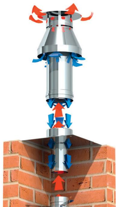
Durch den Abzug der warmen Abgase entsteht in der Gasfeuerstätte ein Unterdruck, der über das Einströmen von Zuluft an der Schornsteinmündung ausgeglichen wird und einen natürlichen Kreislauf erzeugt. Die Zuluft muss zwingend über die Mündung (Wand- oder Dachmündungsabschluss) gezogen werden, da Abgasausblaugen und Zuluftansaugung immer im gleichen Druckbereich stattfinden müssen, damit der sogenannte „Balanced Flue“-Kreislauf funktioniert.
