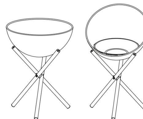
Coloque la semiesfera móvil en el trípode, de manera que dos patas estén en la parte delantera y una esté en la parte posterior. Asegúrese de que la pata trasera no sobresalga en el orificio de la semiesfera.
