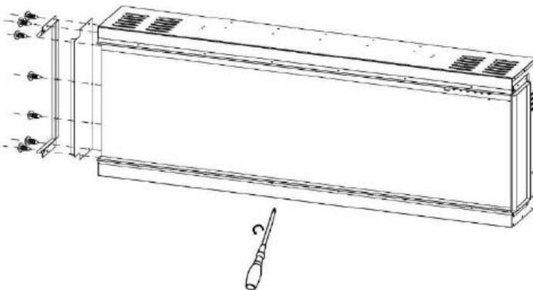
Befestigen Sie nach dem Entfernen der Paneele die Abdeckleisten wieder. Entfernen Sie die Schreibe aus dem Kamin wie in der Abbildung dargestellt.
