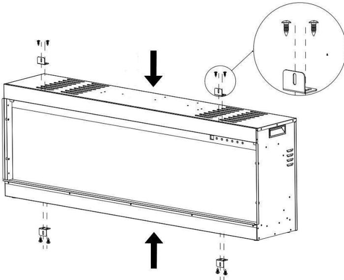
Für Wandeinbaugeräte: Stellen Sie eine Öffnung für den Kamin nach den gewünschten Maßen her. Setzen Sie die Feuerstelle in die Wandöffnung ein. Drehen Sie die Befestigungsschrauben in die Halterungen und die Wandstützen ein.
