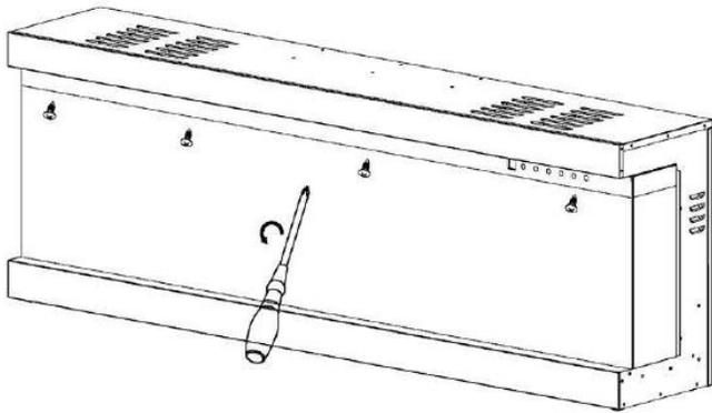
Verwenden Sie einen Schraubendreher um die 4 Schrauben zu entfernen.
