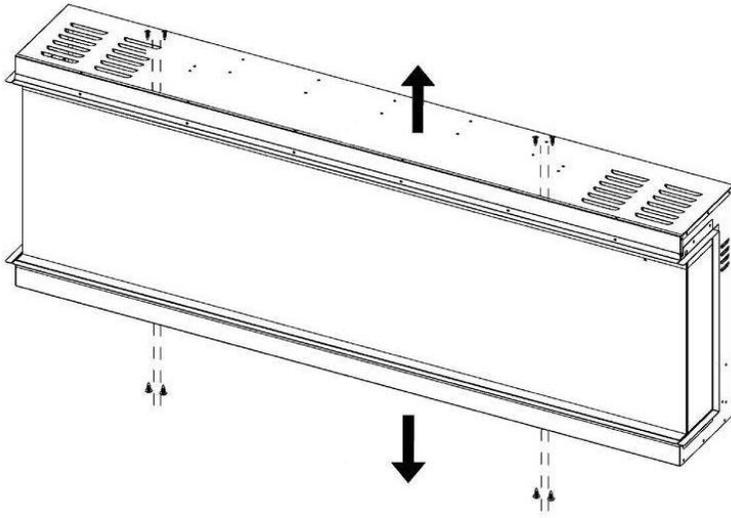
4. Befestigen Sie die Halterungen mit den Schrauben aus dem vorherigen Schritt.
