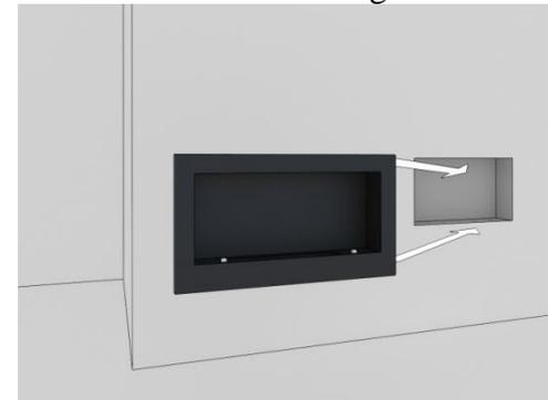
Befestigen Sie es mit den mitgelieferten Schrauben durch die Löcher im Boden der Feuerstelle (nachdem Sie die Dübel montiert haben).
